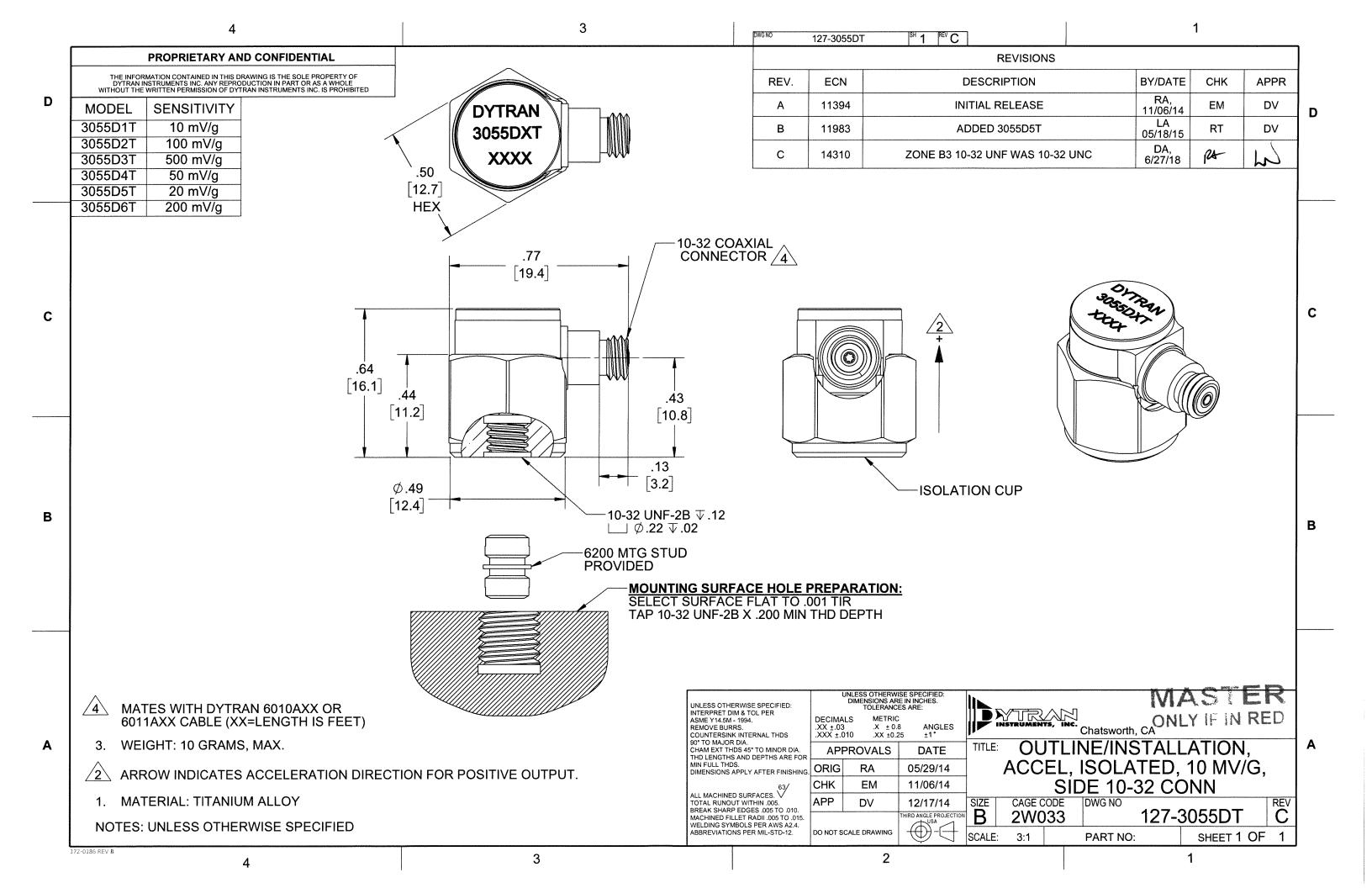
Model Number DOC NO PERFORMANCE SPECIFICATIONS 3055D2T PS3055D2T IEPE ACCELEROMETER REV F, ECN 12776, 06/24/16
